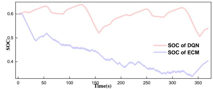
Fig. 7. SOC trajectory of DQL-EMS and ECM-EMS
